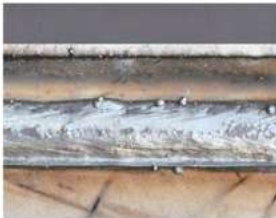
Salpicadura y socavado
